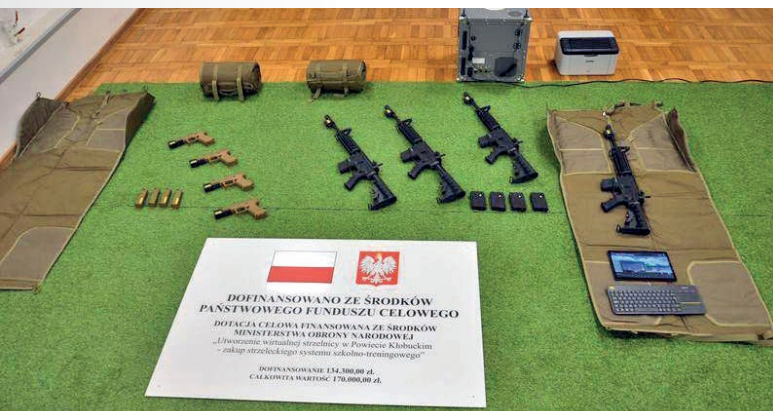
▼ Laserowe symulatory – repliki czterech karabinków i czterech pistoletów działających w systemie VR
